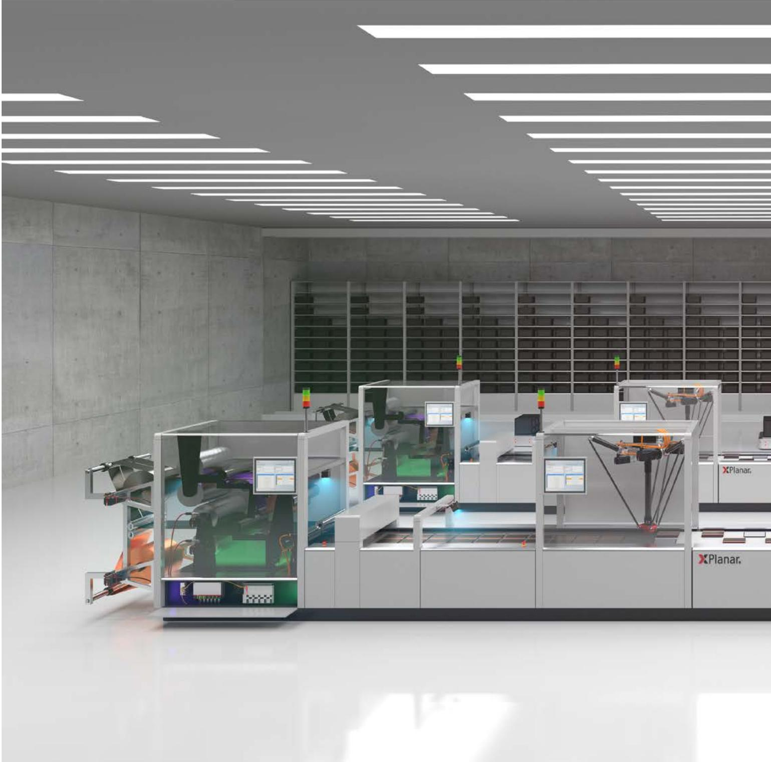
高效地完成这些工艺步骤，可以将连续的产品流自动转换为分段式产品流。电芯则通过悬浮的动子分别输送到各个加工工位，系统可以灵活控制各个工艺步骤，对其进行冗余设计或跳过某个步骤。XPlanar 能够实现非接触输送运动，不会产生任何机械磨损，特别适合用于无尘洁净室。在电池测试方面，倍福除了能够提供机器视觉解决方案之外，还可以提供各种高精度测量端子模块系列。中央控制平台可以直接控制所有工艺技术，并通过支持的协议和接口将这些工艺集成到实时应用中。带本质安全型接口的防爆系列
