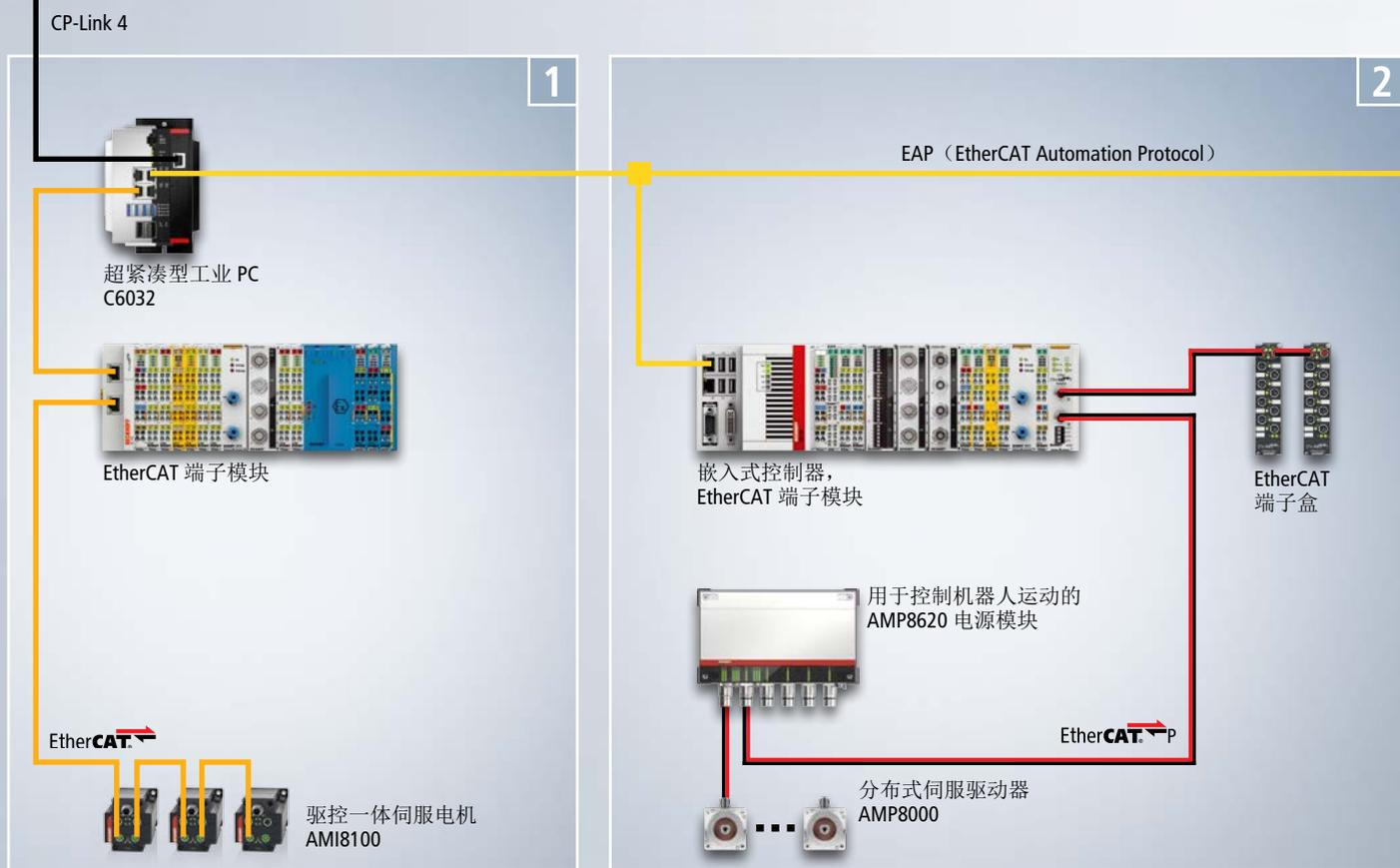
由于 EtherCAT 端子盒的防护等级高达 IP67，因此传感器和执行机构也可以直接迁移到设备上。将 I/O 分布式集成到设备设计中，可以轻松进行扩展和修改配置。我们的运动控制解决方案还具有灵活性高的特点。集中式软件方案使得增加或调整轴都很容易。即使是如飞锯和凸轮盘等复杂的运动控制功能，也可以根据需要进行组合，例如，在使用 AX8000 多轴伺服系统时。
